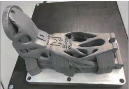
由 M&H CNC Technik GmbH 设计和生产的 Protean 360+ 悬架臂的 3D 打印原型
